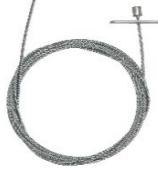
Трос 7*7 диаметром 2мм, длиной 2,15м, с окончанием Сквозной анкер. Гальванизированная сталь, пластина - нержавеющая сталь. Другие длины по запросу | 2,0мм / 45кг          | Китай  | 187,35 ₽   |
